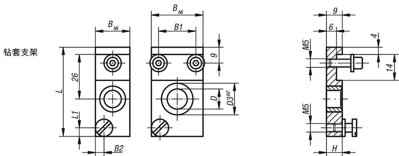
最小孔距  $L_3 = \frac{1}{2} \text{号钻套支架 (尺寸 B) + 2号钻套支架 (尺寸 B)}$
