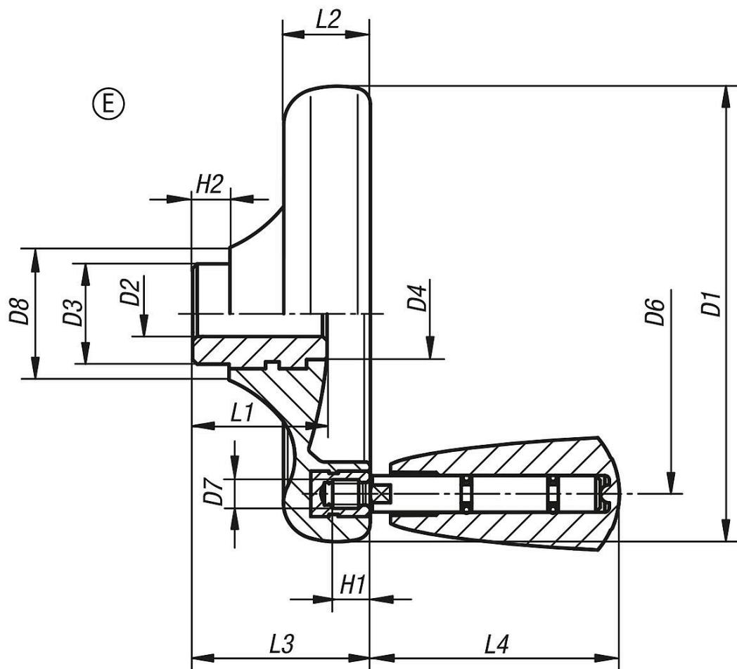
06287\_E inch 手轮盘，带转动手柄，不锈钢金属件，E型，带定位孔 -
