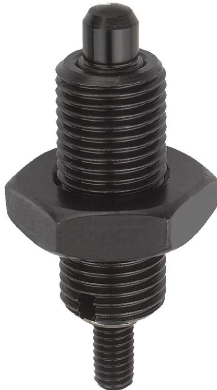
**产品说明****材料 :****钢制 :****顶销硬化处理 :****强度等级 5.8。****不锈钢 :****顶销硬化处理 :****螺纹套筒 1.4305 ( 符合 AISI 303 标准 )。****顶销 1.4034 ( 相当于 AISI 420 )。****顶销未经硬化处理 :****螺纹套筒 1.4305 ( 符合 AISI 303 标准 )。****顶销 1.4305 ( 符合 AISI 303 标准 )。****规格 :****钢制 :****顶销经硬化、抛光和黑色氧化处理。****不锈钢 :****顶销经硬化、抛光和黑色氧化处理。顶销未经硬化、抛光和黑色氧化处理。****根据要求 :****特殊类型。****附件 :****间隔环 03089。****连接嵌入件****用于薄壁部件 03094-10。**
