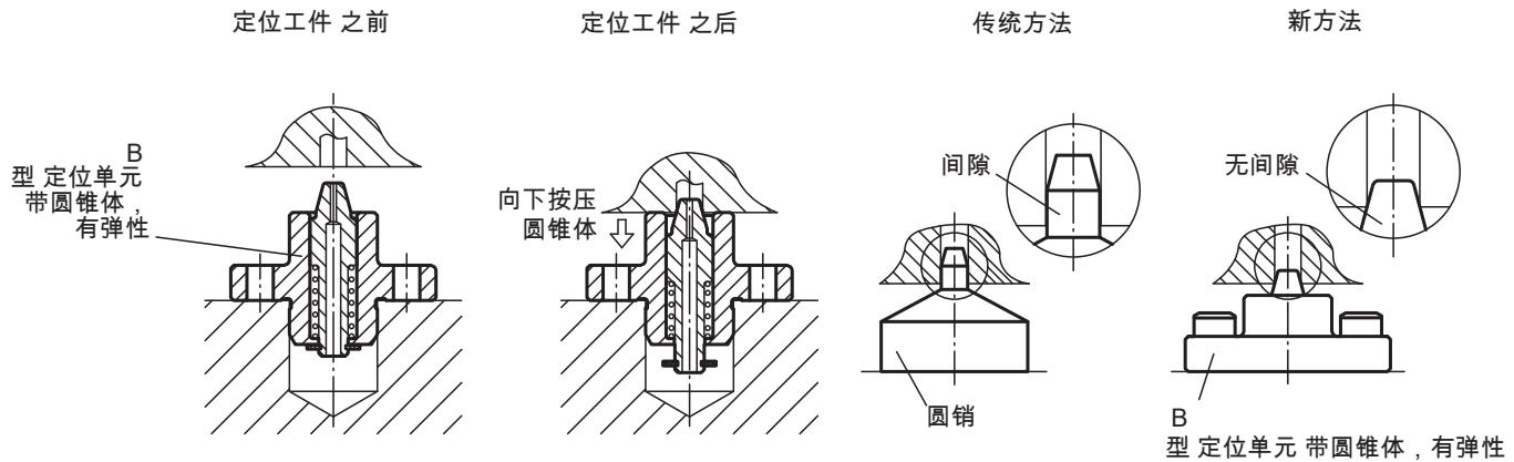
将工件放到定位单元上时，向下移动圆锥体。
